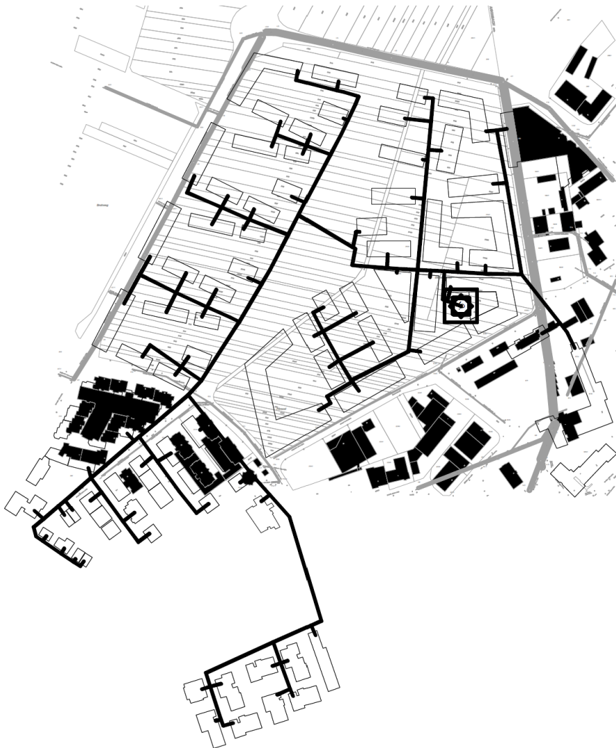
Abbildung 6: Mögliche Verlegung des künftigen Wärmenetzes
